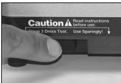
Obrázek 13. Používejte nástroje na úpravu s mírou (viz následující strana pro pokyny).
