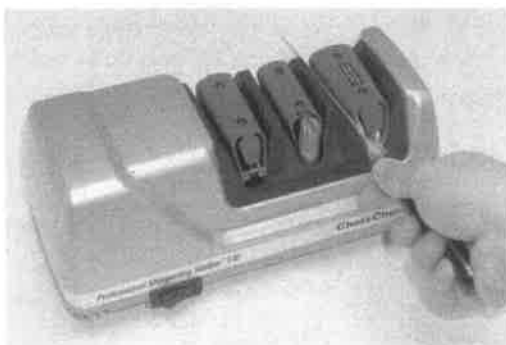
Obrázek 6. Vkládání ostří do otvoru ve Fázi 3.
