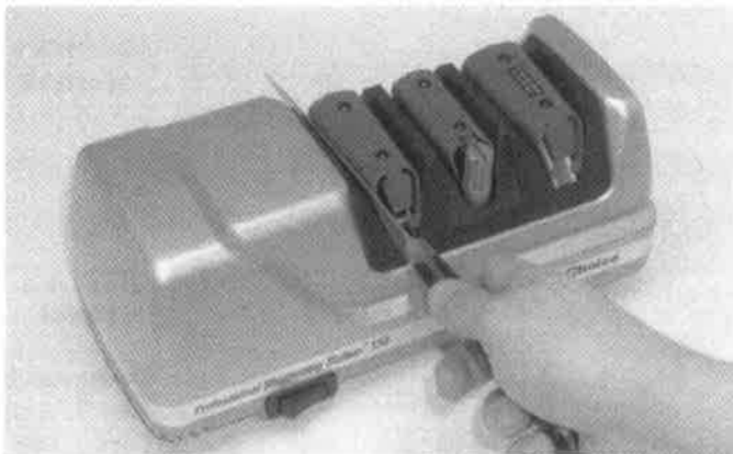
Obrázek 3 – Fáze 3. Vkládání ostří do otvoru mezi sklon a elastickou pružinu
