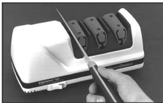
Obr. 3: Stupeň 1 Vložení čepel do štěrbin mezi vodičím prvku a pružnou lamelou. Střídejte levou a pravou štěrbinu.
